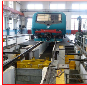
Figura 16 Fossa di verifica
